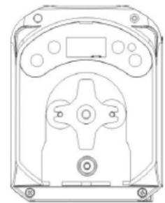
Levantar el tubo por la zona de aspiración e ir girando para su total liberación
