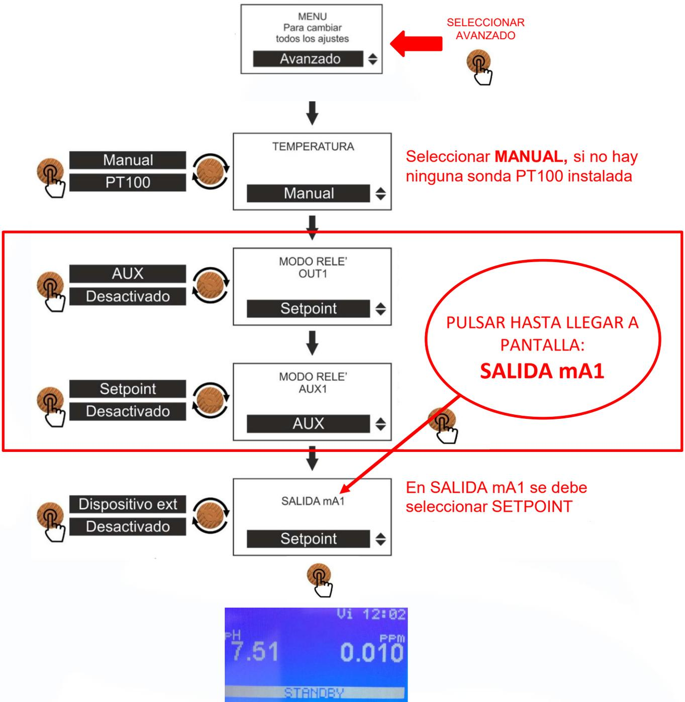
En este punto, nos aparece la pantalla de inicio con el valor del cloro libre en ppm, día, hora y mensaje STANDBY (equipo en espera), para desactivarlo pulsar 3 segundos.
