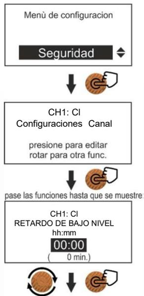
Es posible configurar un retraso en minutos en función del tamaño del depósito usado y de la cantidad dosificada por la bomba.
