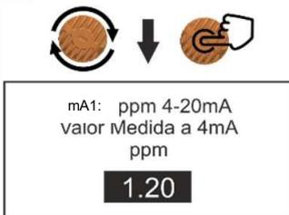
Seleccionar el valor en ppm de 4 mA, es decir, el valor de cloro MÁXIMO donde la bomba dosificadora detendrá su dosificación (en el ejemplo 1,20 ppm).
