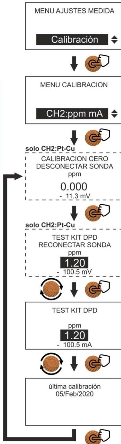
Para calibrar la sonda de cloro es necesario disponer de un fotómetro y de un test kit DPD 1.
