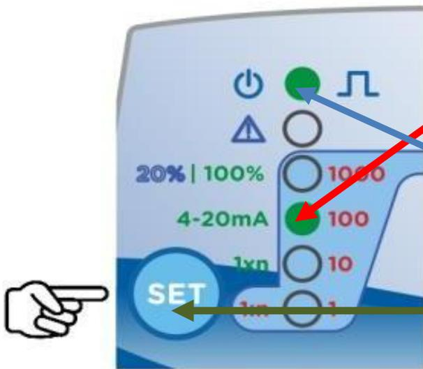
Para que las bombas del panel funcionen en modo proporcional 4 - 20 mA, debe quedar activado el LED **VERDE 4 - 20 mA**
