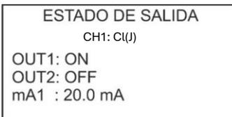
Esta pantalla muestra el estado de funcionamiento de las salidas presentes en el instrumento y sirve de ayuda para monitorizar su funcionamiento.
