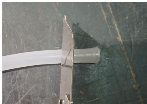
Corte del extremo del tubo
