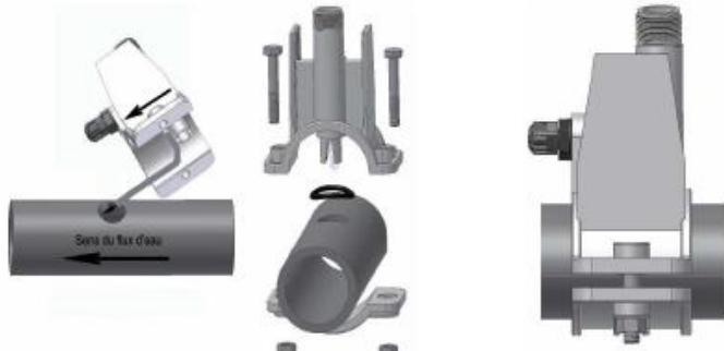
Montaggio del tubo 4 x 6 (rif. 2) sugli elementi **d e f g** dello schema di collegamento idraulico
