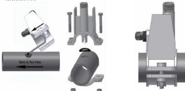
Montage du tuyau (rep 2) sur les accessoires aux endroits **d e f g** du schéma de raccordement hydraulique :
