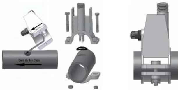
Montaje del tubo 4 x 6 (ref. 2) en los elementos d e f g del esquema de conexión hidráulica
