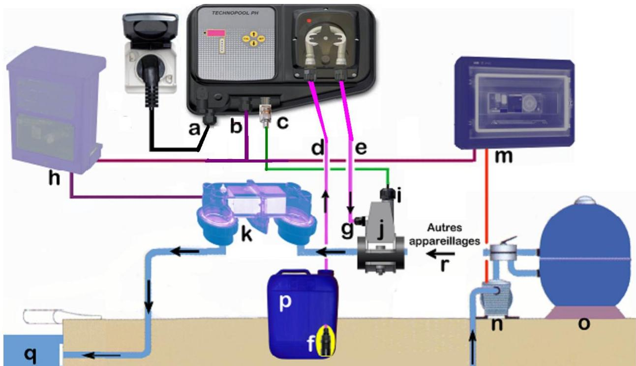
**a** : Câble avec prise destinée à être branchée dans une prise murale classique 230 Vac
