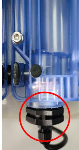
4.- Volver a colocar la sonda Pt - Cu con cuidado de no dañar la espiral de platino.
