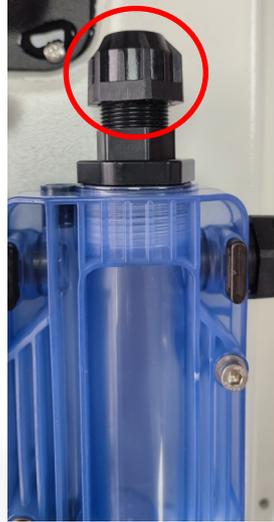
2.- Desenroscar el racor porta sondas de la parte superior del electrodo Pt - Cu y "ligeramente" ¡¡ SIN QUITARLO !! el tapón de rebose. Introduzca por arriba unas gotas de ácido clorhídrico (sulfumán) al 10 % y déjelo actuar muy pocos minutos. Enrosque los distintos elementos y reestablezca el flujo de agua.
