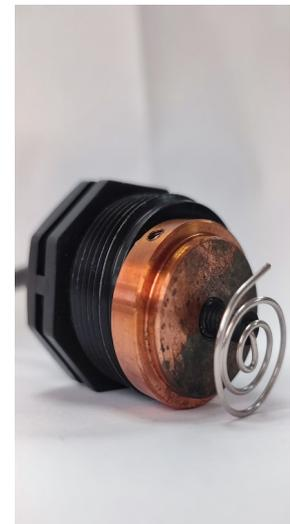
3.- Limpie el electrodo de cobre con papel ligeramente áspero. ¡¡ No tocar la espiral de platino!! En caso necesario limpie la parte del cobre con sulfumán al 10 % y enjuagar con agua.
