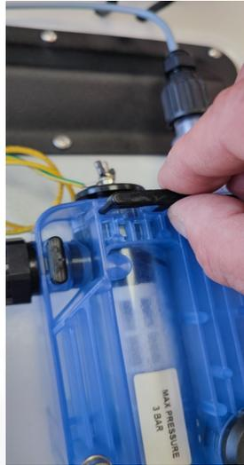
2.- Retirar la grapa que asegura el soporte de la conexión a tierra y el filtro lavable de protección, extrayendo posteriormente el conjunto por la parte
