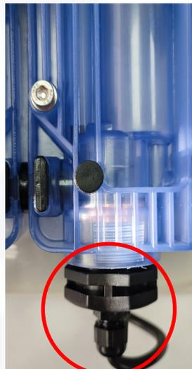
2.- Desenroscar el racor porta electrodo Pt - Cu con cuidado de no perder las esferas de vidrio que contiene. Se recomienda poner un recipiente debajo para evitar que se extravíen.
